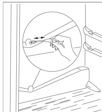
Чистку отверстия для слива талой воды проводите с помощью специального ершика, поставляемого в комплекте и изображенного на рисунке. Ершик храните прямо в сливном отверстии.
